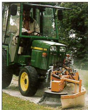
Drahtseil- oder Kunststoff-Bündel fächern sich beim Geräteinsatz nach und nach zu einer kraftvollen Bürste auf und „fegen“ die oberirdischen Pflanzenteile regelrecht ab. Dank der Schraubhülsen läßt sich der Besatz leicht und schnell wechseln.
